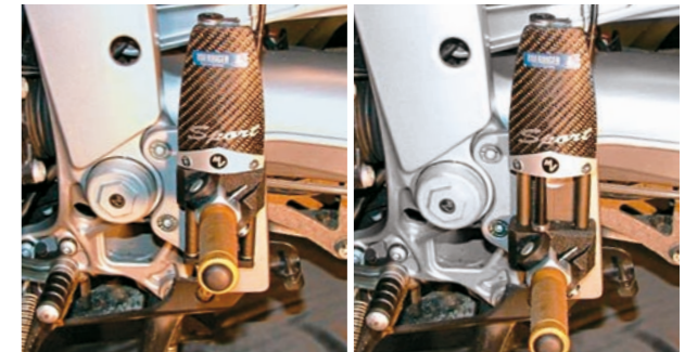
Hydraulik-Raste: In drei Sekunden von oben (li.) nach unten (re.)
