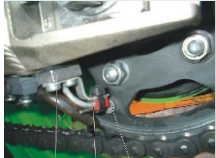
Bild 1 Befestigung des Magneten und Sensors
