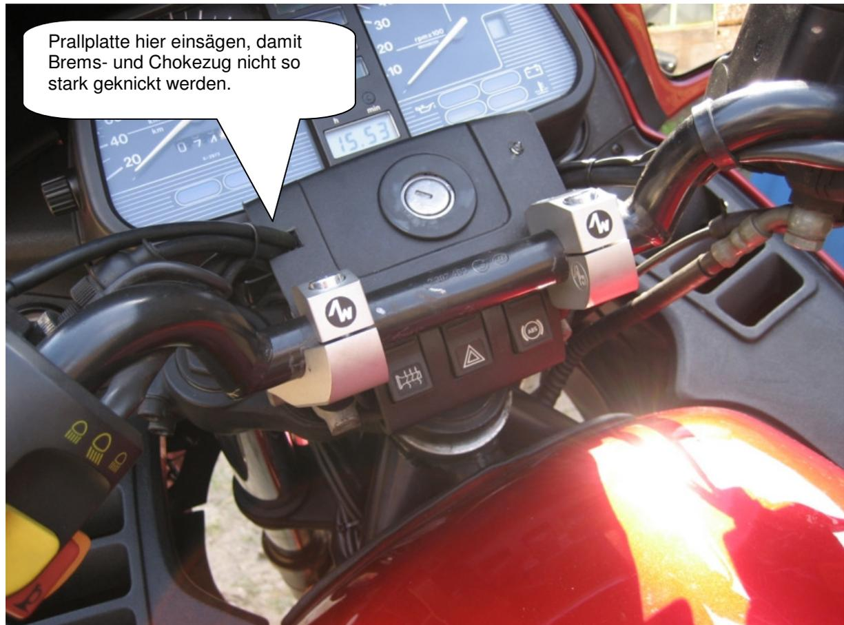
Zum Schluss alle Kabel wieder mit Kabelbindern befestigen und prüfen, dass bei vollem Lenkeinschlag alle Kabel und Züge genügend Spiel haben und nirgendwo scheuern!
