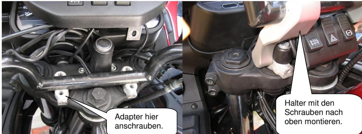
Den Kupplungs- und Gaszug aushängen und bei Seite legen, damit diese später um verlegt werden können. Bremsschlauchverlängerung montieren - siehe Bild. Jetzt kann der Lenker demontiert werden, um die beiden beiliegenden Lenkeradapter montieren zu können.
