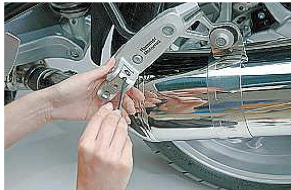
Durch wechselseitiges anziehen können Sie den Adapter soweit ausrichten, das eine senkrechte Position erreicht wird.
