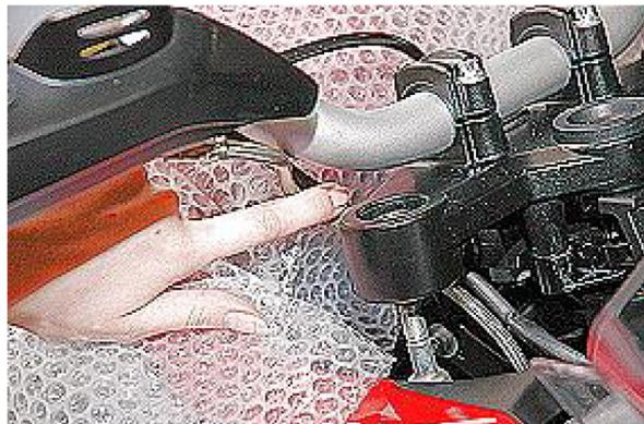
Es können beide Tauchrohre gleichzeitig gelöst werden. Achten Sie darauf das die Maschine auf dem Hauptständer steht.
